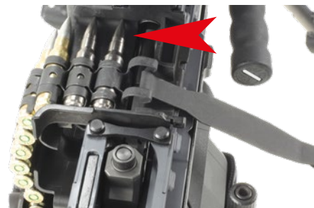
Abb. 33 - 36: Ladetätigkeit mittels der sog. Einführstücke, die sowohl für den Fest- als auch den NATO-Zerfallgurt funktional identisch existieren. Wenn es sehr schnell gehen muss oder die Ladetätigkeit staubgeschützt durchgeführt werden soll, ist das Einführstück ideal, da es das seitliche Einschieben des Gurtes ohne Deckelöffnung ermöglicht und gleichzeitig das stressbedingt fehleranfällige Einlegen des Gurtes von oben überflüssig macht. Stattdessen wird der Gurt über das Einführstück zwangsgesteuert von links in den Zuführschacht eingeführt und damit vertikal wie horizontal „zentriert“. Ein weiterer Vorteil ist, dass der Bediener so stressresistent die Waffe quasi „halbteilladen“ kann (linke Photos) indem er das Einführstück nur bis zum ersten Einrasten des Gurtes rechts herauszieht – entsprechend ist dies von außen auch erkennbar, weil das Einführstück dann in einem flachen Winkel rechts aus der Gurtauswurfenster ragt. Der Bediener kann die Waffe aber gurtseitig auch „volteilladen“, indem er das Einführstück vollständig bis zum Anschlag nach rechts aus der Waffe zieht, welches dann erkennbar in einem deutlich steileren Winkel aus der Waffe herabhängt. Eindeutig erkennbar ist das vollständige Teiladen vor allem aber daran, dass nur in diesem Fall – sofern sich die Patrone (über der verlängerten Rohrseelenachse) in Zuführposition befindet – auch die rote Ladeanzeige oben aus dem Deckel austritt. Die beschriebenen (Teil)ladetätigkeiten mittels Einführstück können unabhängig von der Verschlussstellung erfolgen. Einziger Nachteil der Einführstücke kann sein, dass bei unmittelbar vor der Ladetätigkeit leereschossener Waffe immer ein oder zwei Glieder des gerade verschossenen Zerfallgurtes in der Waffe verbleiben und sich eventuell im Gurtschacht verklemmen können, sofern der Deckel nicht geöffnet und diese manuell entfernt
