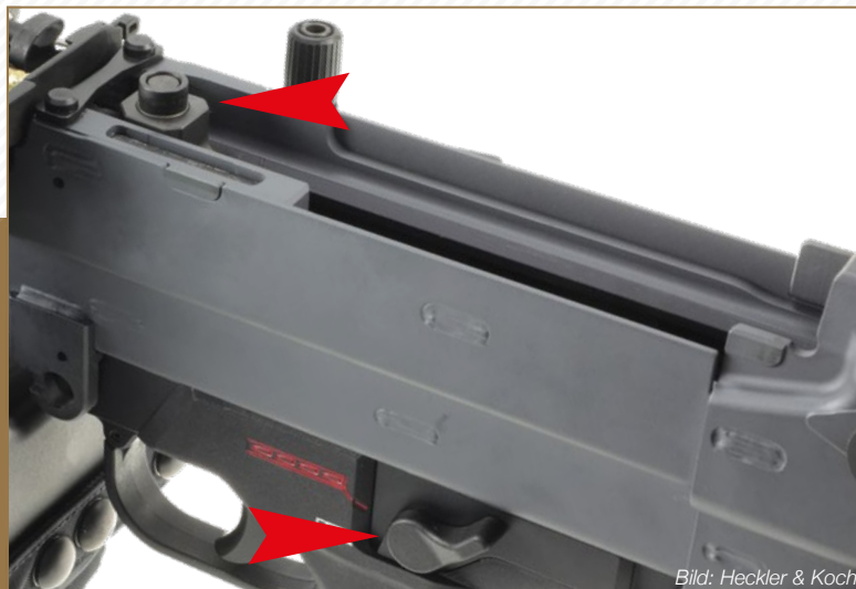
Abb. 10: Das „Sichern in allen Verschlusspositionen“ ermöglicht das sog. „gesicherte Durchladen“ – der Verschluss befindet sich in entspannter, vorderster Verschlussstellung und der Sicherungs-/Feuerwahlschalter befindet sich gleichzeitig auf Stellung „Sicher“; das Durchladen kann nun gesichert erfolgen.
