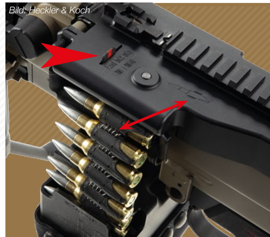
Abb. 38: HK421 mit „Rüstsatz Festgurt“ und eingelegtem DM1/DM10/DM140-Festgurt. Die Deckelgravur nennt die DM-Nummern des Bundeswehr-Festgurtes und zeigt unten eine Patronen-Silhouette mit Festgurtglied, erkennbar an den stilisierten Spiraldrähten links und rechts. Oben ist der Ladeanzeiger zu sehen, dessen rot markierte Fahne oben aus dem Deckel tritt sobald ein Gurt in die Waffe eingelegt und diese vollständig teilgeladen ist; entsprechend ist der Ladeanzeiger auch bei Dunkelheit fühlbar. Es sind auch Deckelvarianten ohne integriertes Klappvisier und Ladeanzeiger verfügbar. Auf der Gurttasche sind ebenfalls stilisierte Gurtglieder abgebildet, damit der Nutzer im Stress sofort erkennt, mit welchem Ende der Gurt zuerst und mit welcher Seite nach oben dieser eingelegt werden muss; das Ost-MG PK/PKM führt nämlich den Gurt von rechts zu und beim G8 muss der Gurt mit der offenen Seite nach oben eingelegt werden.
