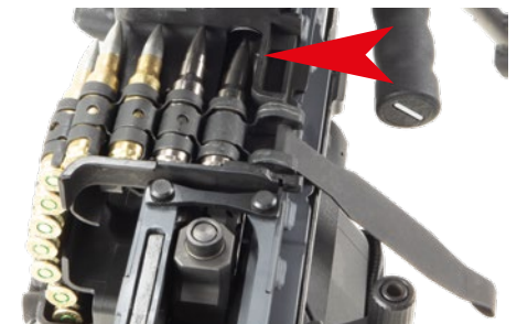
Abb. 33 - 36: Ladetätigkeit mittels der sog. Einführstücke, die sowohl für den Fest- als auch den NATO-Zerfallgurt funktional identisch existieren. Wenn es sehr schnell gehen muss oder die Ladetätigkeit staubgeschützt durchgeführt werden soll, ist das Einführstück ideal, da es das seitliche Einschieben des Gurtes ohne Deckelöffnung ermöglicht und gleichzeitig das stressbedingt fehleranfällige Einlegen des Gurtes von oben überflüssig macht. Stattdessen wird der Gurt über das Einführstück zwangsgesteuert von links in den Zuführschacht eingeführt und damit vertikal wie horizontal „zentriert“. Ein weiterer Vorteil ist, dass der Bediener so stressresistent die Waffe quasi „halbteilladen“ kann (linke Photos) indem er das Einführstück nur bis zum ersten Einrasten des Gurtes rechts herauszieht – entsprechend ist dies von außen auch erkennbar, weil das Einführstück dann in einem flachen Winkel rechts aus der Gurtauswurfenster ragt. Der Bediener kann die Waffe aber gurtseitig auch „volteilladen“, indem er das Einführstück vollständig bis zum Anschlag nach rechts aus der Waffe zieht, welches dann erkennbar in einem deutlich steileren Winkel aus der Waffe herabhängt. Eindeutig erkennbar ist das vollständige Teiladen vor allem aber daran, dass nur in diesem Fall – sofern sich die Patrone (über der verlängerten Rohrseelenachse) in Zuführposition befindet – auch die rote Ladeanzeige oben aus dem Deckel austritt. Die beschriebenen (Teil)ladetätigkeiten mittels Einführstück können unabhängig von der Verschlussstellung erfolgen. Einziger Nachteil der Einführstücke kann sein, dass bei unmittelbar vor der Ladetätigkeit leereschossener Waffe immer ein oder zwei Glieder des gerade verschossenen Zerfallgurtes in der Waffe verbleiben und sich eventuell im Gurtschacht verklemmen können, sofern der Deckel nicht geöffnet und diese manuell entfernt
