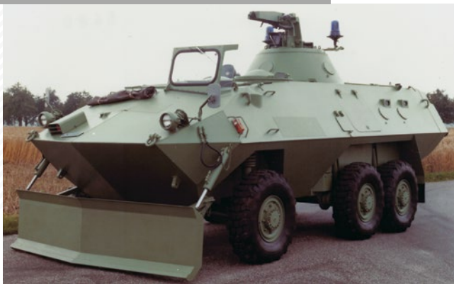
Abb. 47: Zeitgenössisches Foto eines gepanzerten Polizeifahrzeuges aus den 1980er Jahren mit Turmlafette und eingebautem G8. Die Waffe war fast vollständig „eingehaust“ und somit nicht nur gegen Umwelteinflüsse, sondern auch zumindest gegen unmittelbaren Zugriff von Störern geschützt, welche bspw. bei Demonstrationen auf die Polizeifahrzeuge stiegen um dies zu beschädigen. Solche Schutzmaßnahmen für die Einbauwaffen haben zwar ihre Grenzen – bspw. gegen flüssige Brandsätze (Molotow Cocktails) - machen aber in jedem Fall Sinn; vor allem wenn man an robustere (Auslands)einsatzszenarien denkt, in denen auch die Splitterwirkung von Handgranaten und RPGs schnell ein Thema werden kann.
