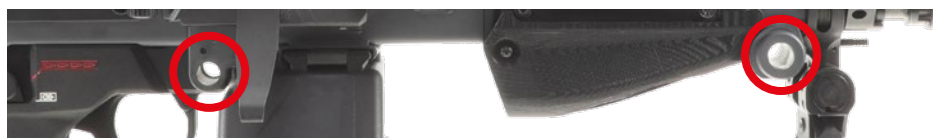
Abb. 48/49 : Lafettenschnittstelle der Gewehre G8/HK21/ HK81, jeweils mit und ohne dazugehörige Lafette – links neben den beiden Absteckbolzen der Schulterstütze ist der hintere Aufnahmebolzen zu erkennen, links neben dem Rohrwechselgriff ist der Nutenstein an der Gehäuseunterseite als vorderer Lafettenaufnahmepunkt zu erkennen. Auch wenn diese Schnittstelle ganz offensichtlich von der des MG3 inspiriert war, sind diese leider nicht identisch bzw. austauschbar. Hinzu kommt, dass der Hülsenauswurf bei MG3 und MG5 jeweils nach unten erfolgt, während dieser bei G8 und HK421 zur Seite erfolgt.
