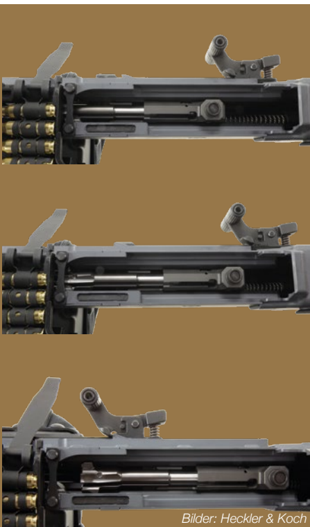
Abb. 12 - 14: Die Bildfolge 12 zeigt die zwei definierten Zwischenstellungen (oben und mitte), in denen der Verschluss durch zusätzliche Sicherheitsfangrasten bei unvollständiger Rücklaufbewegung in einer sicheren Stellung gefangen wird, sofern bspw. bei unvollständiger Durchladebewegung der Verschluss nicht regulär in hinterster Position gefangen wird. Unten zum Vergleich die hinterste und somit reguläre Fangposition des Verschlusses bei vollständigem Rücklauf bzw. vollständig gespannt nach dem Durchladen.
