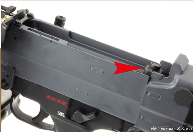
Abb. 11: Nach dem gesicherten Durchladen befindet sich der Verschluss in bestimmungsgemäßer hinterster Position wie bei anderen marktgängigen Waffen, welche aus offener Verschlussstellung schießen, wie z. B. das MG3 oder MG5.
